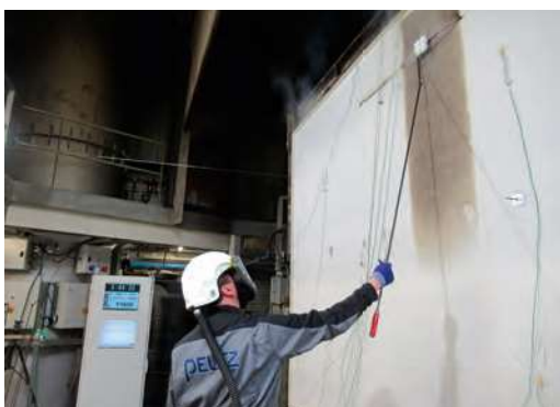
Brandtest volgens EN 1364-1: niet-dragende houtskeletbouw buitengevel.
