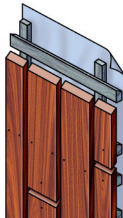
Tekening 4 Verticale open gevelbekleding op dubbel regelwerk.
