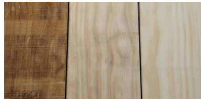
VERKLEURING: RUW OPPERVLAKE, NA AFSCHAVEN VAN 3MM EN NA AFSCHAVEN VAN 6 MM VAN HET RUWE OPPERVLAKE
